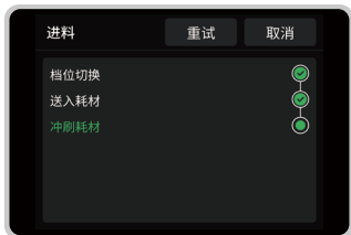
b. 等待进料完成，建议用手协助推入耗材，以确保耗材进料成功；
