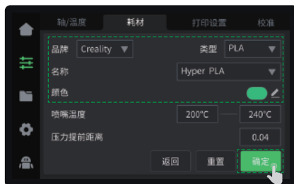
③ 手动点击屏幕设置耗材信息：调整页面→耗材→编辑（如图料架下方），分别设置耗材品牌-类型-名称-颜色，最后点击确定即可保存设置；
