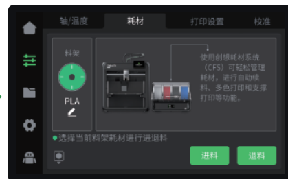
③ 手动点击屏幕设置耗材信息：调整页面→耗材→编辑（如图料架下方），分别设置耗材品牌-类型-名称-颜色，最后点击确定即可保存设置；
