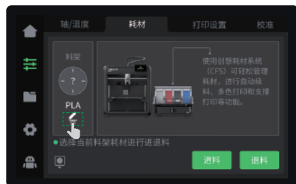
③ 手动点击屏幕设置耗材信息：调整页面→耗材→编辑（如图料架下方），分别设置耗材品牌-类型-名称-颜色，最后点击确定即可保存设置；
