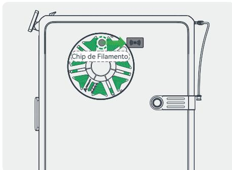
1 Si los filamentos admiten el reconocimiento RFID, alinea el chip en los filamentos con la posición de reconocimiento RFID del cuerpo de la máquina para escanear los filamentos, y la información del filamento se puede configurar automáticamente.
