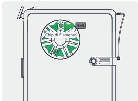
1 Se i filamenti supportano il riconoscimento RFID, allineare il chip sui filamenti con la posizione di riconoscimento RFID del corpo macchina per scansionare i filamenti e le informazioni sui filamenti verranno impostate automaticamente.
