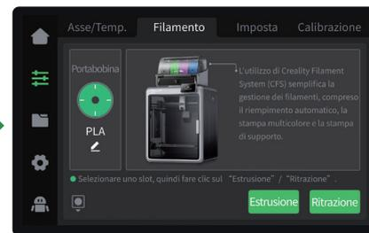
4 Se i filamenti non supportano il riconoscimento RFID, Tocca manualmente lo schermo per impostare le informazioni del filamento: Pagina di regolazione → Filamento → Modifica (come mostrato sotto al portamateriali). Imposta il marchio, il tipo, il nome e il colore del filamento e infine clicca su "Si" per salvare le impostazioni.
