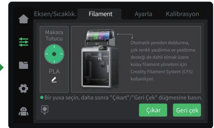
3 Filament bilgilerini ayarlamak için ekrana manuel olarak dokunun: Ayar sayfası → Filament → Düzenle (malzeme rafının altında gösterildiği gibi). Filament markasını, türünü, adını ve rengini ayarlayın ve son olarak ayarları kaydetmek için "Evet"ya tıklayın.
