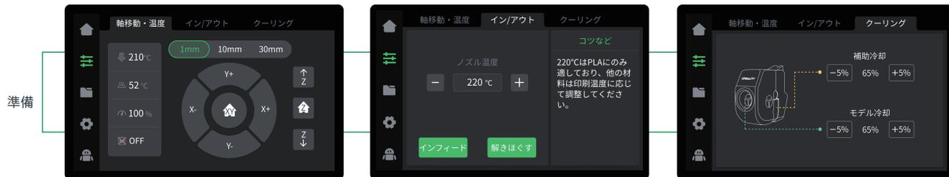
\* 軸移動/温度、イン/アウト、クーリングなどの機能を準備インターフェースを介して設定できます。
