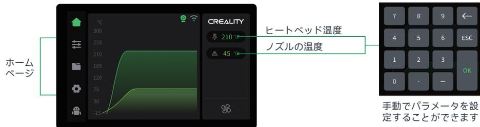
\* ホームページを通して押出機の温度および温床の温度のような機能を形成できます;
