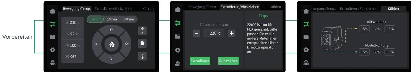
\* Über die Vorbereitungsschnittstelle können Sie Funktionen wie Achsenbewegung / Temperaturregelung, Extrudieren / Einfahren und Lüfterkühlung konfigurieren.
